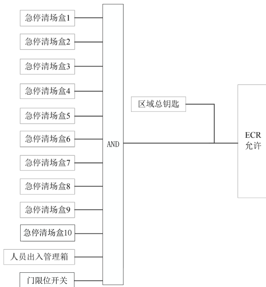
图 4.1.2-15 加速器大厅出束联锁逻辑图
